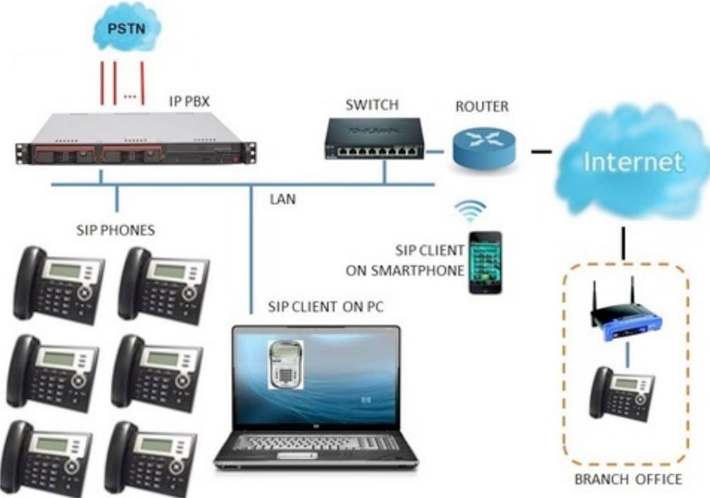
Perangkat IP PBX terdiri dari hardware Inter Server, dan VoIP Gateway 4 FXO, sedangkan Software adalah PBX System dengan kapasitas 250 extension.
